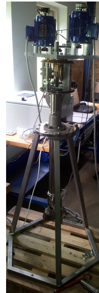
Figure 2: Gunclean Toftejorg. Högst upp syns motorerna ovanpå växellådan, längst ner syns munstycket som "ritar upp" sprutmönstret
